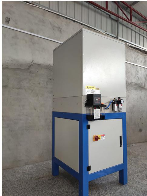
干冰去毛刺 让您无刺可挑剔，定位技能高：用精密度极好的轴承制成的，关于空隙调整起来也很便利。承重大、硬度高：能够进行淬火工作。操作简单易上手：利用干冰原理去除毛刺干净无死角，这样就可以保证工件美观、一致的去毛刺效果，避免了刚性主轴去毛刺不均匀。可靠性高、寿命长、噪音小、轰动小、精度高的长处；为了解决手机金属外壳纳米注塑后精加工而产生的金胶结合软毛刺的痛苦问题，衍生出许多去除毛刺的工艺方法 如：人工去毛刺，喷砂去毛刺等工艺。为了规避人工或喷尼龙砂去毛刺工艺给产品带来结构性瑕疵。干冰去毛刺机，历经270多天的现场实际操作使用，获取丰富的应用需求数据，经过四次迭代升级，现已达到国际主流设备性能需求。
